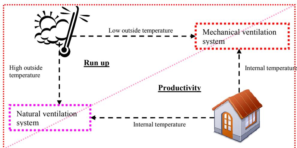
Figure1. Principal control system of ventilation Principiālā ventilācijas vadības shēma
