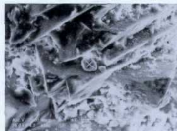
2. attēls. SEM/EDS rezultāti, analīzes vieta atzīmēta ar "X". Dolomīta ( \text{CaCO}_3\text{MgCO}_3 ) fragmenta izgulsnēšanās uz kalcīta kristāla skaldnēm.
