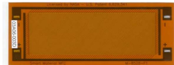
**Fig. 2.** MFC actuator.
