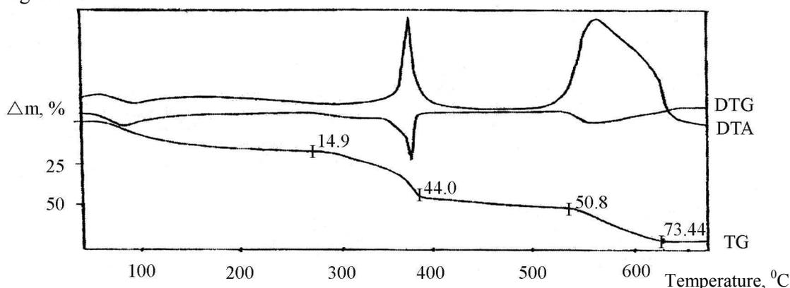
**Fig.1.** Thermogravimetric curves of sodium sorbitolborate
