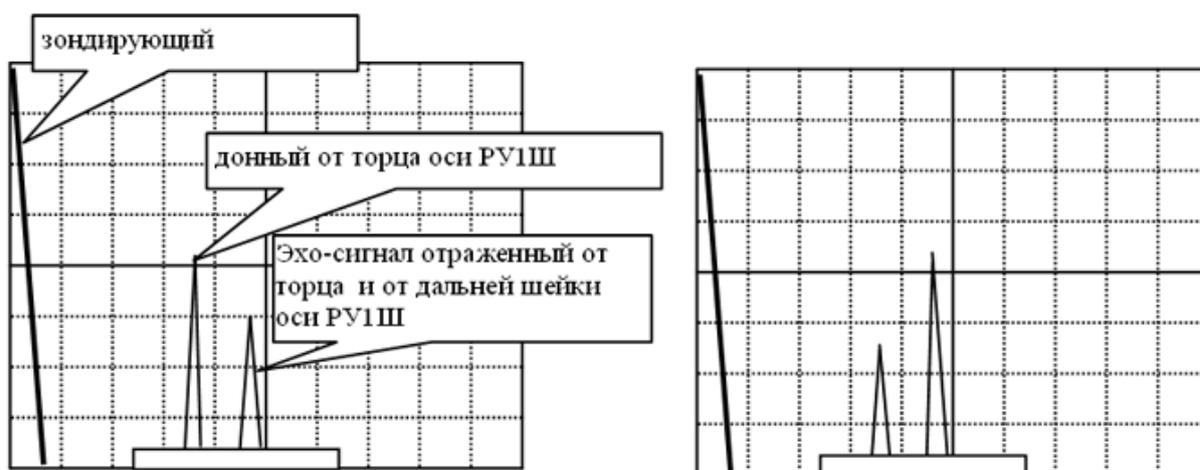
**Рис. 4.** Принятые эхо-сигналы на экране ЭЛТ УДС2-32 в режиме 02А-ПОИСК для оси РУ1Ш: а – вне болтового отверстия; б – в точке  $X_0$ , которая соответствует месту максимального перекрытия болтового отверстия с ПЭП
