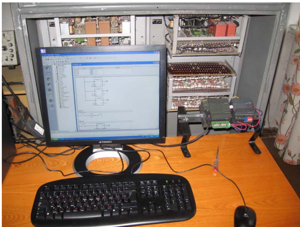
Рис. 3. Среда программирования MicroWIN и фрагмент программы на языке Ladder
