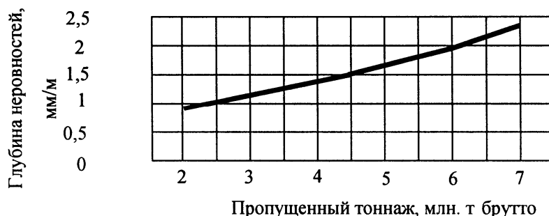
Рис. 2. Изменение глубины неровностей на поверхности катания рельсов по мере наработки тоннажа
