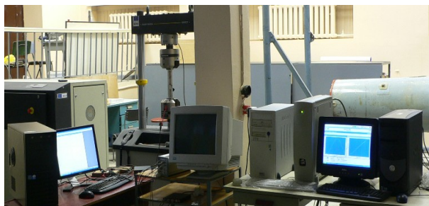
Фиг. 12. Испытательная машина с установленным образцом и подключенной контрольно-измерительной аппаратурой при усталостных испытаниях.
