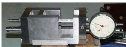
Фиг. 5. Общий вид устройства для создания предварительного растяжения перфорированной дюралюминиевой наклейки.
