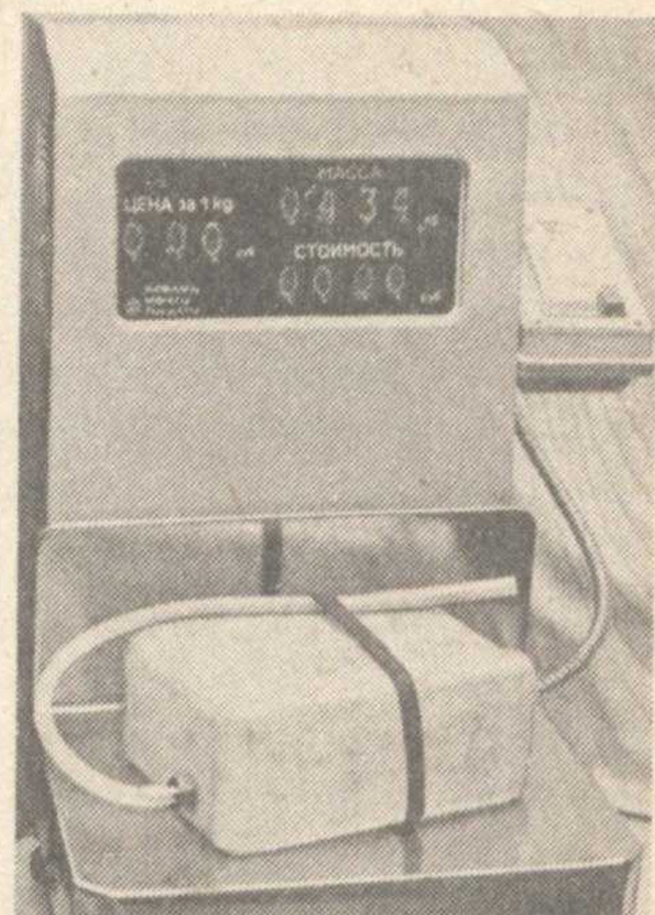
Patērētā degvielas daudzuma noteikšana ar elektroniskajiem svāriem.
