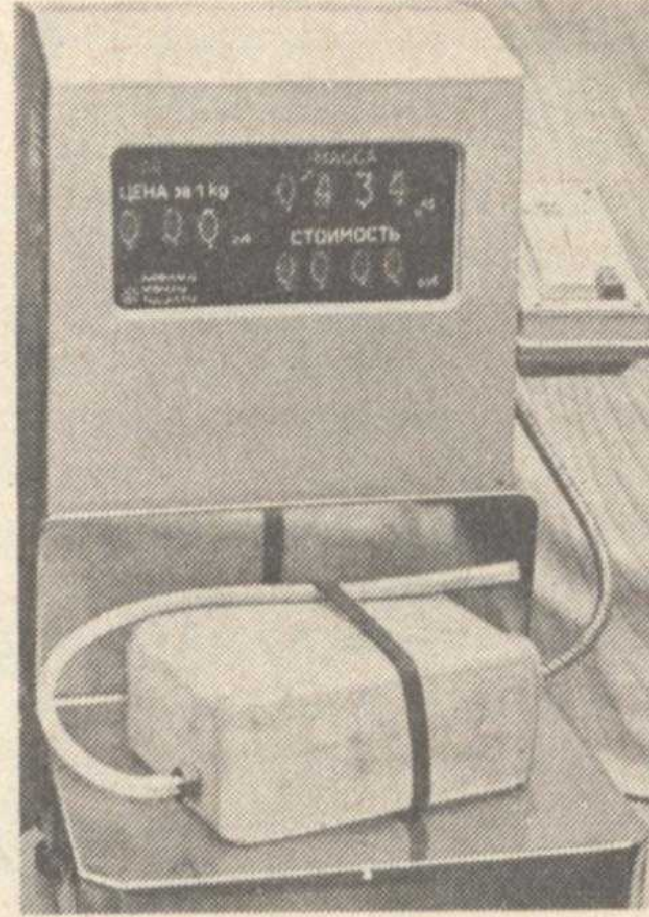
Определение количества израсходованного бензина на электронных весах.
