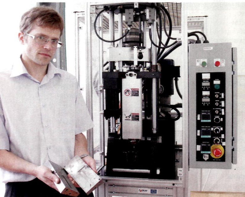
Remo Merijs Meri demonstrē, kā iekārtā liešanai zem spiediena no otrreizējā polietilēntereftalāta izgatavo jaunus izstrādājumus.
