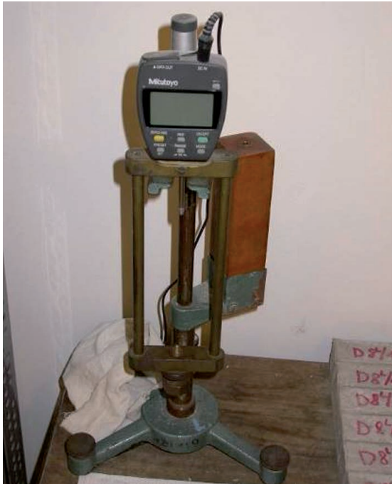
Fig. 2. Graaf-Kaufmann device with Mitutoyo comparator (minimum measurement interval 0.001 mm) with reference specimen 2. ábra Graf-Kaufmann készülék digitális Mitutoyo hosszváltozás-mérővel (felbontás 0,001 mm) és referencia etalonnal
