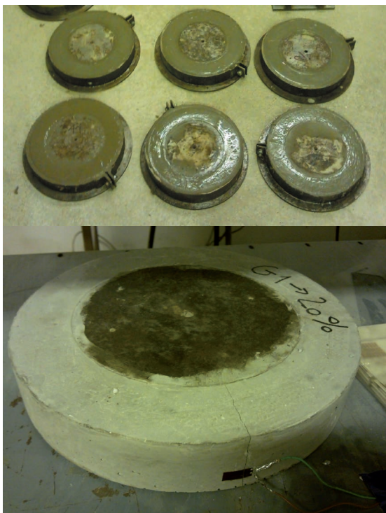
Fig. 3. The preparation and testing of ring specimens for early age cracking tendency 3. ábra A korai zsugorodási repedésérzékenység vizsgálata gyűrű alakú próbatesteken
