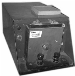
Fig. 5. PEMF generator. ( U = 380 \text{ V} , W = 0,4 \text{ kJ} )
