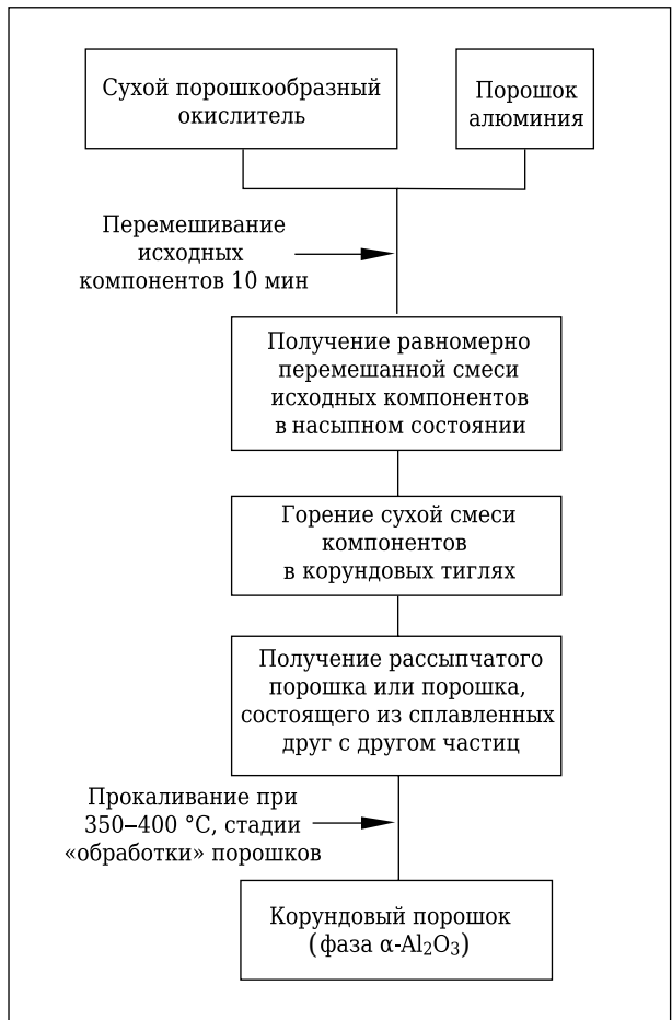
Рис. 1. Схема приготовления сухой смеси исходных компонентов, проведение синтеза горения и стадий «обработки» порошка
