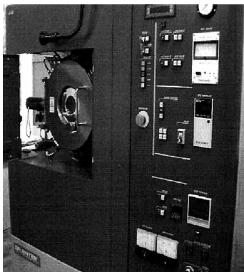
Рис. 2. Оборудование, используемое для плазменно-искрового спекания (модель SPS, Sumimoto, 825E, Япония)
