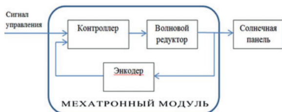
Рис. 4. Блок-схема мехатронного модуля солнечной панели
