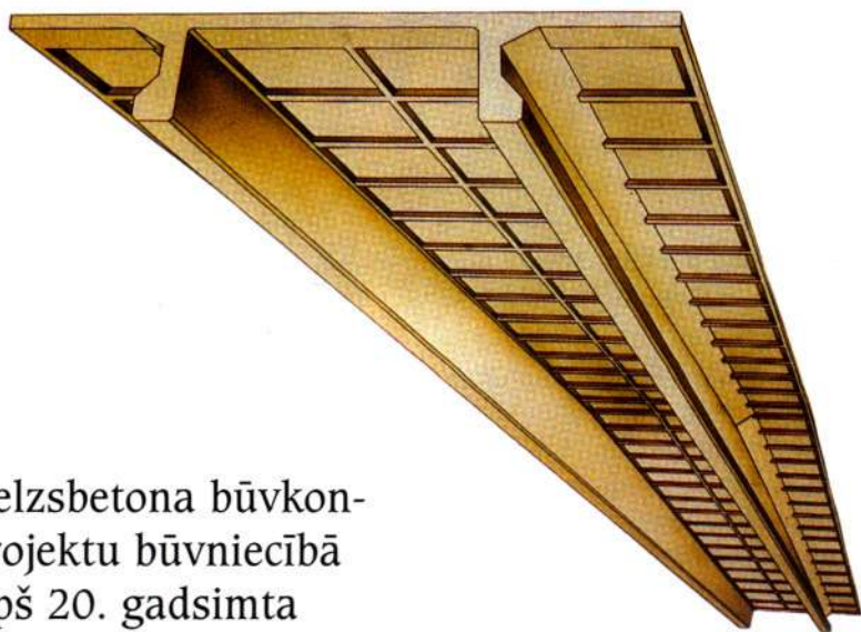
Dvīslīpju TT tipa jumta plātnes izstrādātas, lai nodrošinātu racionālu un estētisku risinājumu industriālajām būvēm.
