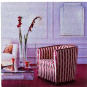
1. att. «Spoguļu» veidošana uz telpas sienas ar polistirola profiliem
