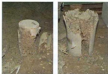
3. attēls. Cilindri pēc spiedes sabrukuma. Kreisais attēls ar berzi (slogotā cilindra virsma bez plaisām, jo ir berzes saturēta), labais – ar dubultām teflona plātnēm, kuras novērš berzi (slogotā virsma izjukusi, jo nav berzes saturēta) [3].
