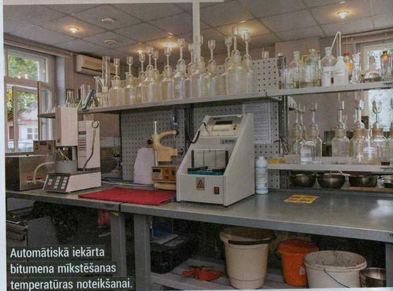
Automātiskā iekārta bitumena mīkstēšanas temperatūras noteikšanai.
